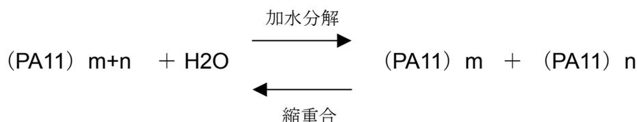
水が過剰に存在した時には、加水分解反応が起こり分子の長さが短くなります。これにより、外観上、つやが消えたり、気泡のような欠陥が無くても、樹脂の機械強度が落ちる事もあります。
